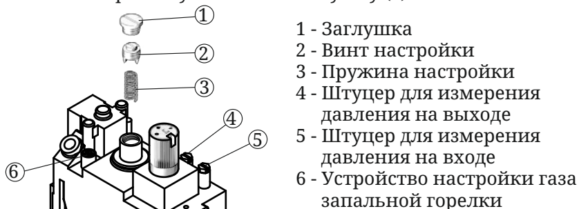
Рисунок 8. Элементы настройки давления подачи газа
