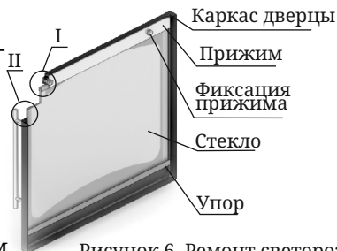
Рисунок 6. Ремонт светорозрачного экрана дверцы модификации «Люмина»
