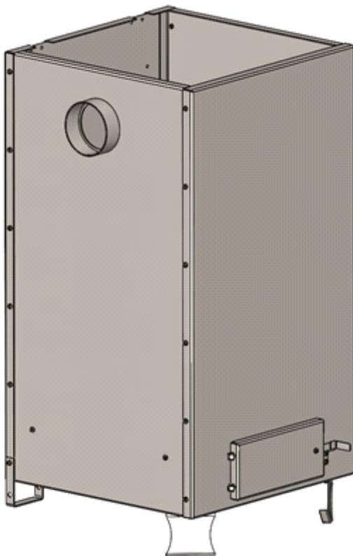
**Совет:** Винты в нижней части конструкции закрепить будет проще, используя открытую зольную дверцу.
